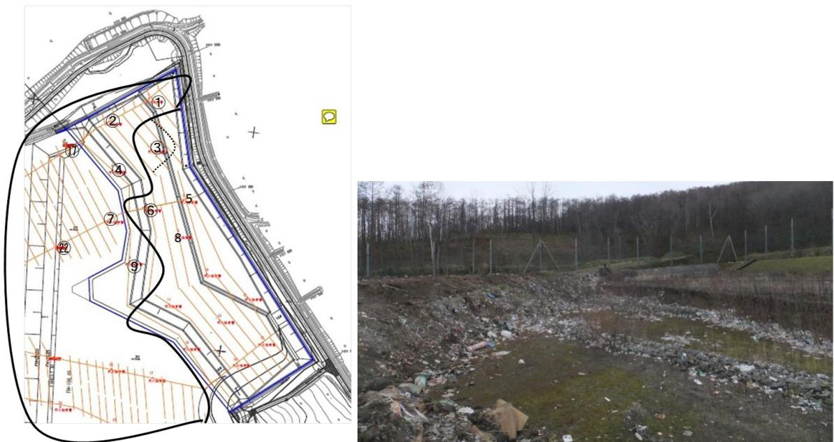
図 4-9 2 期区画のガス抜き管位置図(拡大版)
