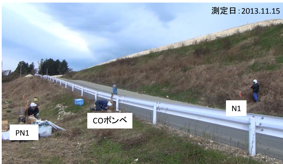
(b) トレーサー応答試験の測定状況
