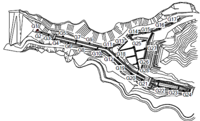
図1-6 伏谷埋立場のガス抜き管位置 5)
