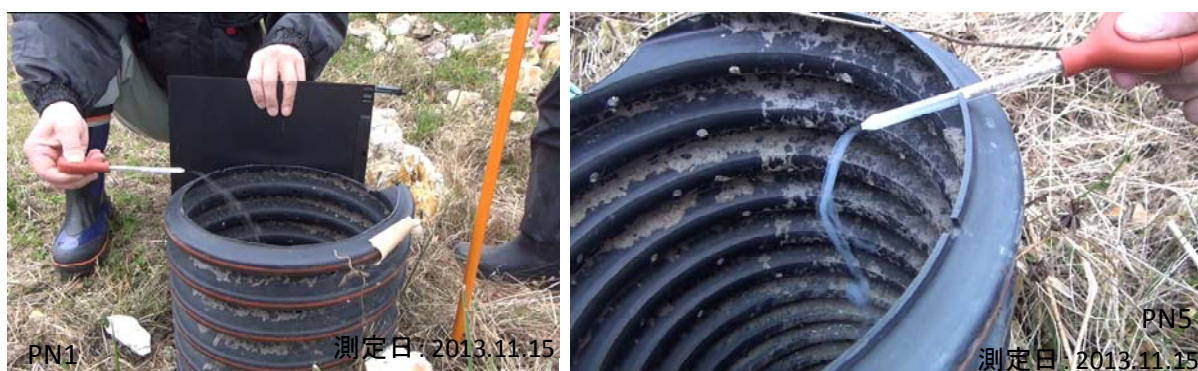
(a) 空気が流入しているガス抜き管 (PN1、PN5)
